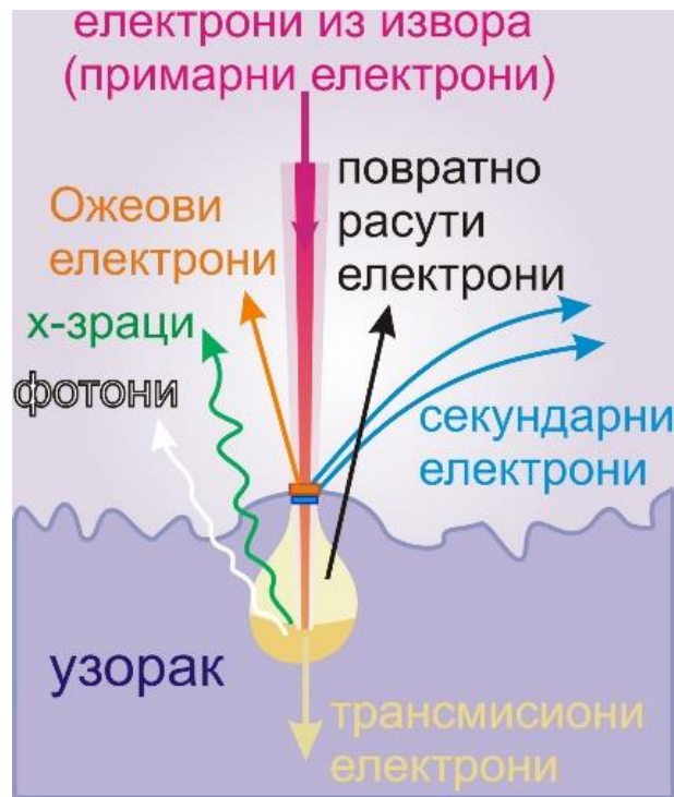
Сл.61 Илустрација интеракције упадног снопа електрона са материјалом код SEM микроскопа [144]
