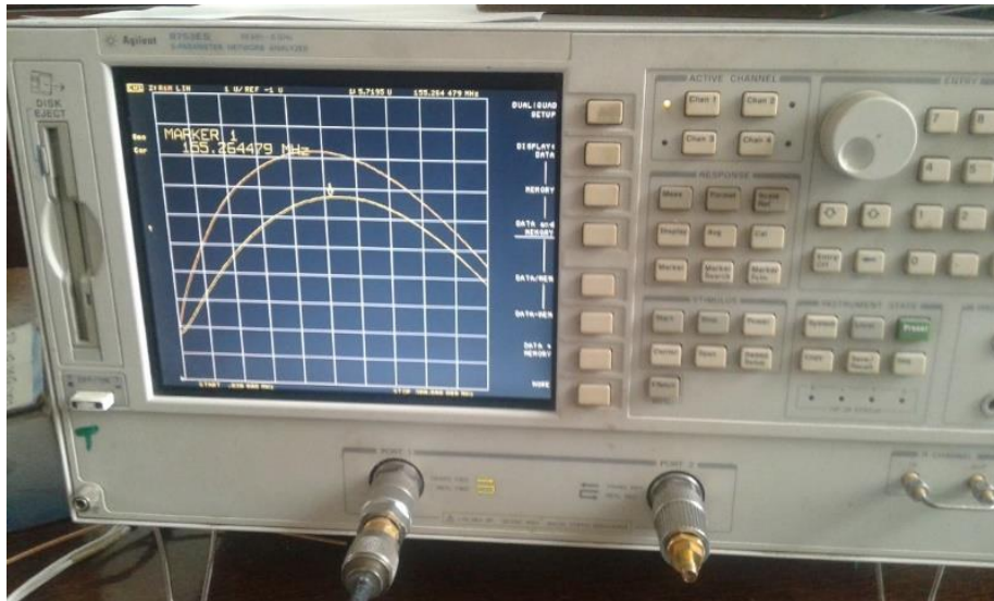
Сл. 51 Резултати мерења импедансе инструментом VNA за приказом првог мерења.
