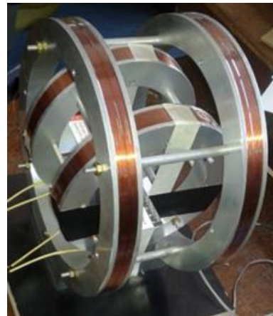
Сл. 44 Два пара Хелмхолцових калемова постављених попречно један у односу на други
